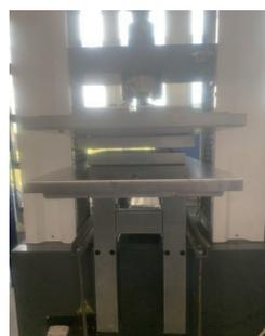
图4 压力试验机
