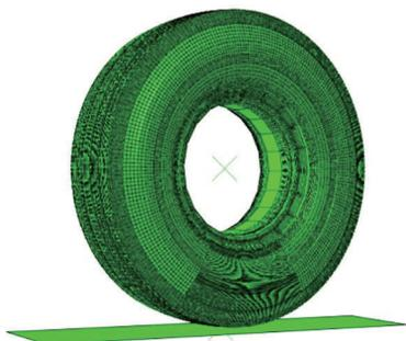
图2 轮胎三维有限元模型
