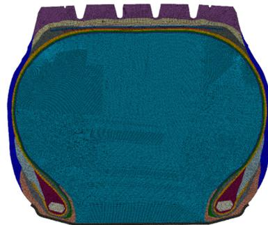
图1 带有空气腔的轮胎有限元分析模型
