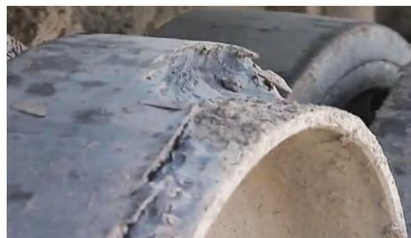
图1 破坏失效的负重轮
