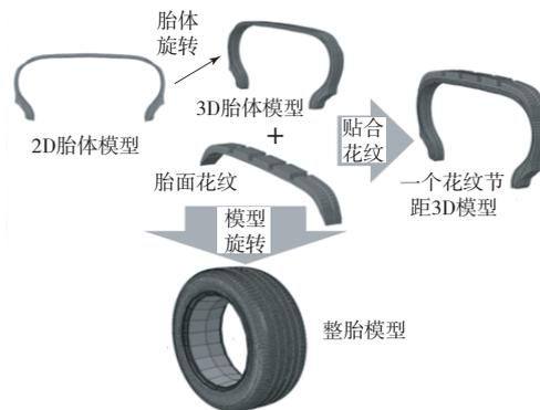
图2 带复杂花纹轮胎的三维有限元模型建模流程
