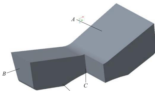
图8 产品外表面和内部测量点示意
