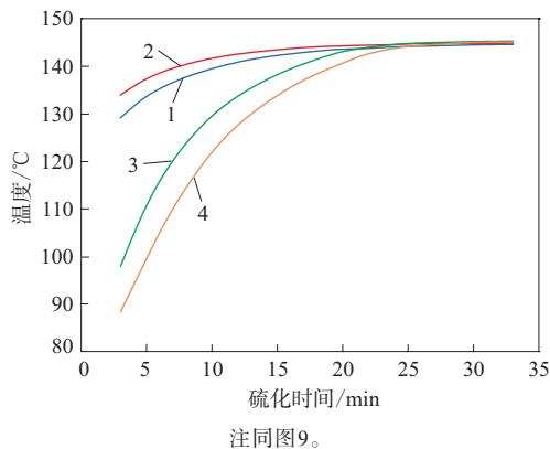
图10 温度随硫化时间的变化曲线
