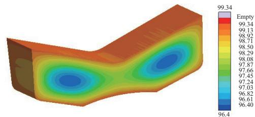
图6 硫化33 min时产品纵向剖面的硫化程度分布云图
