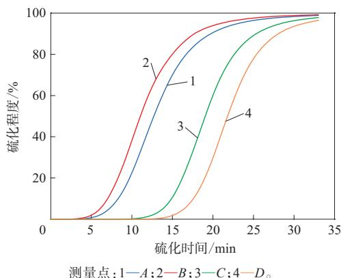
图9 硫化程度随硫化时间的变化曲线
