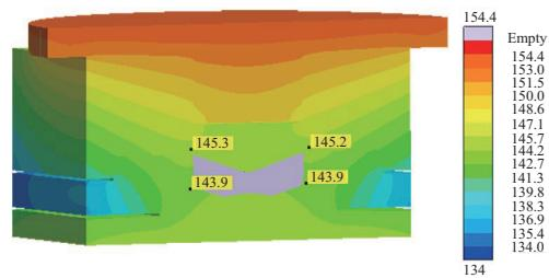
图5 预热3 h后模具温度分布云图
