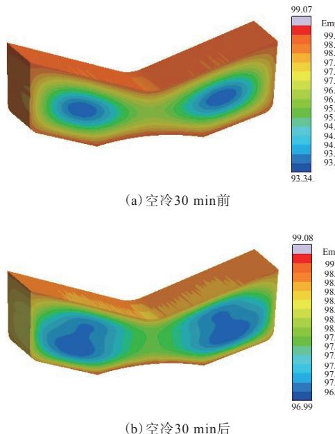
图13 空冷30 min前后产品纵向剖面硫化程度分布云图
