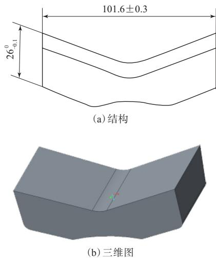
图2 弹性车轮的弹性体元件结构示意
