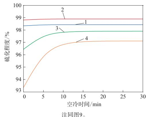
图11 硫化程度随空冷时间的变化曲线
