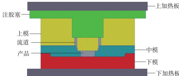
图3 模具、流道和产品的三维模型纵切剖面示意
