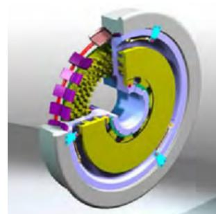
图1 弹性车轮示意(玫红色部分为弹性体元件)
