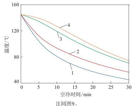
图12 温度随空冷时间的变化曲线
