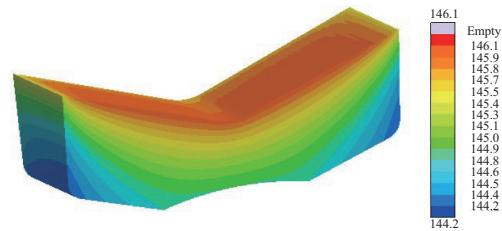
图7 硫化33 min时产品纵向剖面的温度分布云图
