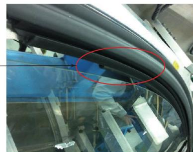
图8 优化结构后的玻璃导槽密封条装车效果
