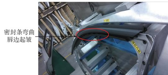
图1 玻璃导槽密封条弯曲唇边起皱
