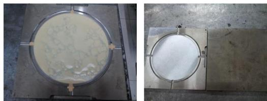
图1 IIR/EPDM混合试样制作模具
