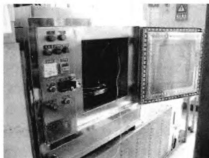
图2 胶料加热用微波炉
