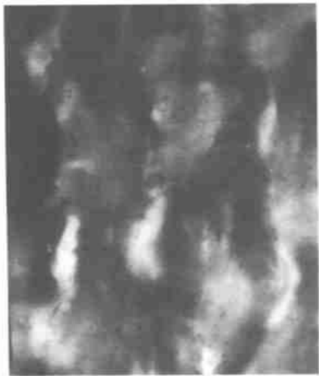
图8 De-link/CA 并用改性 GRT/废 PP 复合材料的 TEM 照片
