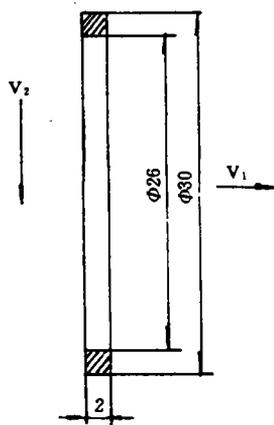
图2 A<sub>3</sub>钢圈结构示意图
