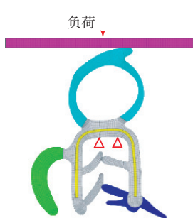
图4 尾门密封条的压缩仿真边界及加载
