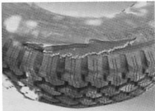
图44 受撞击帘线断裂,胎肩、胎侧起鼓(V)
