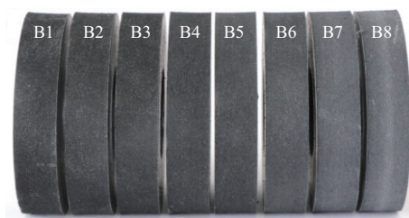
图10 不同落粉速度下试样的磨耗表面
