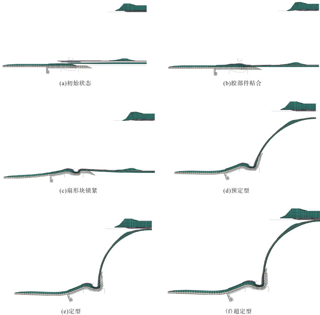
图3 轮胎的成型-定型仿真过程
