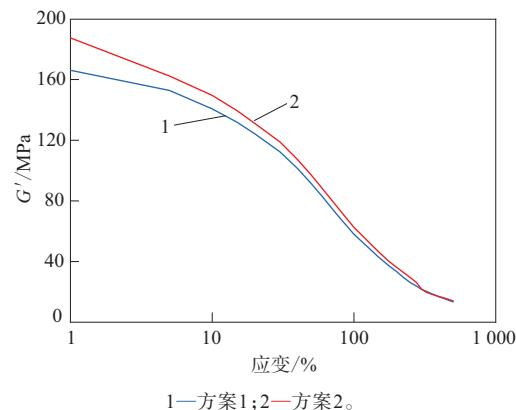
图1 方案1和方案2胶料的 $G'$ -应变曲线
