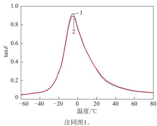
图2 方案1和方案2硫化胶的 $\tan\delta$ -温度曲线
