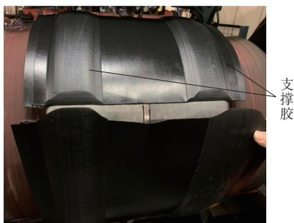
图3 平鼓面轮胎成型示意
