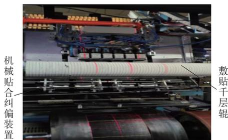
图6 二次法成型机敷贴装置改造示意
