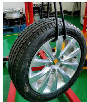
图1 自由状态下轮胎模态测试
