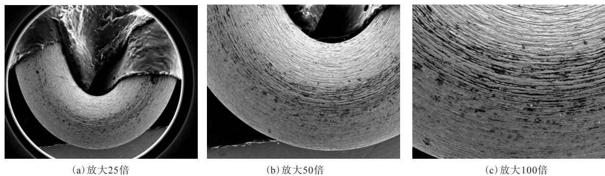
图3 弯曲180°后异常胎圈钢丝表面形貌
