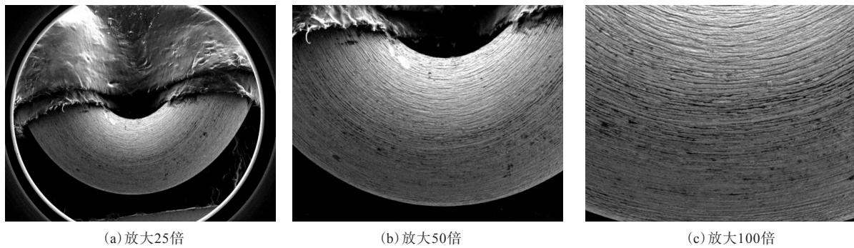
图4 弯曲180°后正常胎圈钢丝表面形貌
