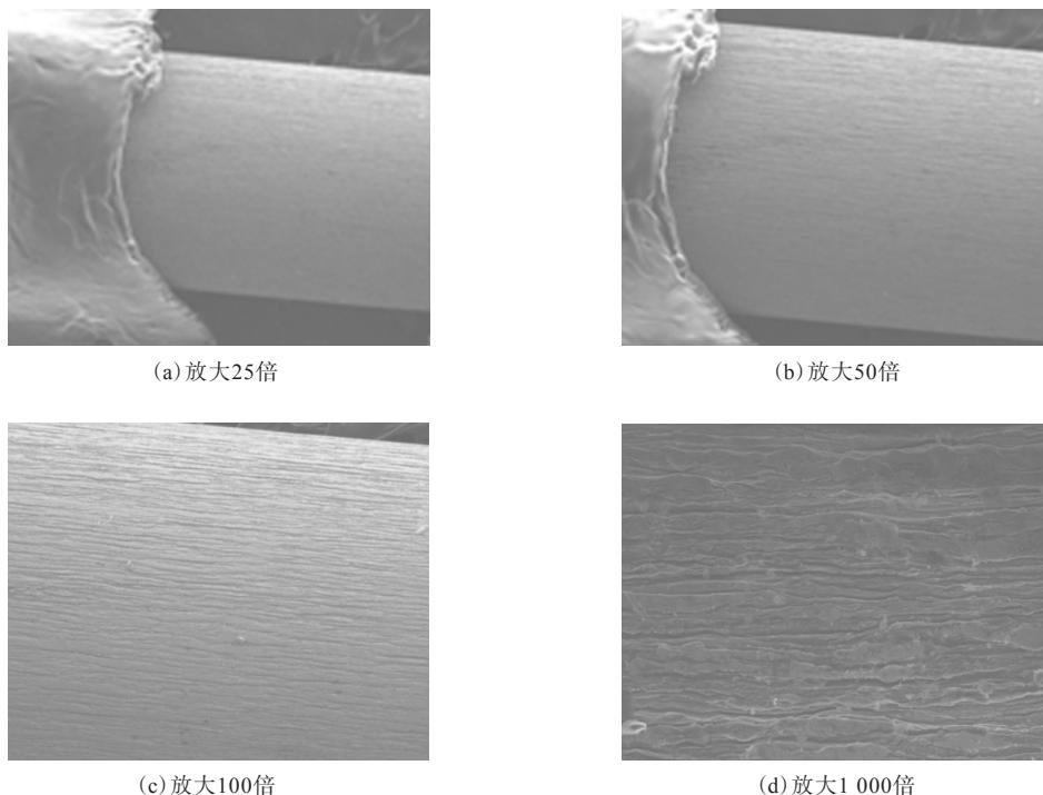
图2 未经处理的正常胎圈钢丝表面形貌
