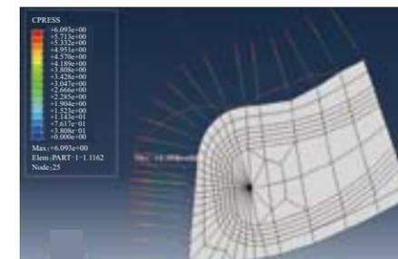
图10 方案B胎圈接触压力分布云图
