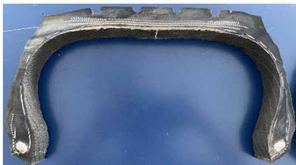
图2 返回轮胎切割断面
