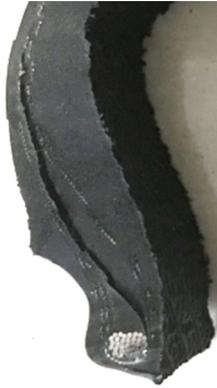
图6 薄三角胶破坏示意
