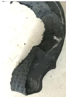
图7 厚三角胶破坏示意
