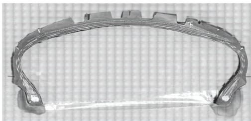
图6 芳纶帘线轮胎断面
