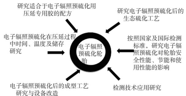
图5 电子辐照预硫化技术在轮胎中的应用研究
