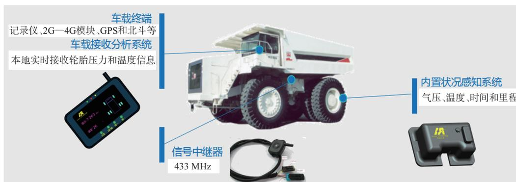
图6 系统安装位置示意
