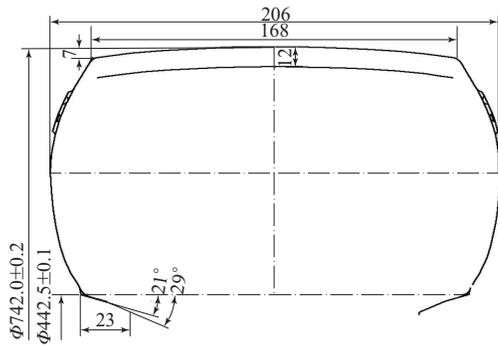
图1 轮胎断面轮廓示意
