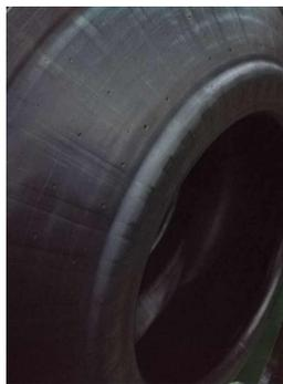
**图2 胎坯圈口胎体帘布端点翘起现象**
