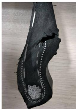
**图1 耐磨胶与钢丝圈包布打褶造成的胎圈裂口现象**
