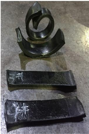
图3 过渡层胶拉伸测试结果
