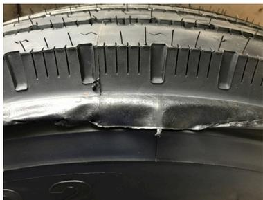
图2 胎坯材料过多造成的薄胶边
