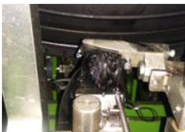
图3 直接修剪溢胶示意
