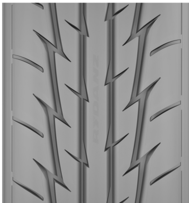
图4 胎面花纹三维效果示意
