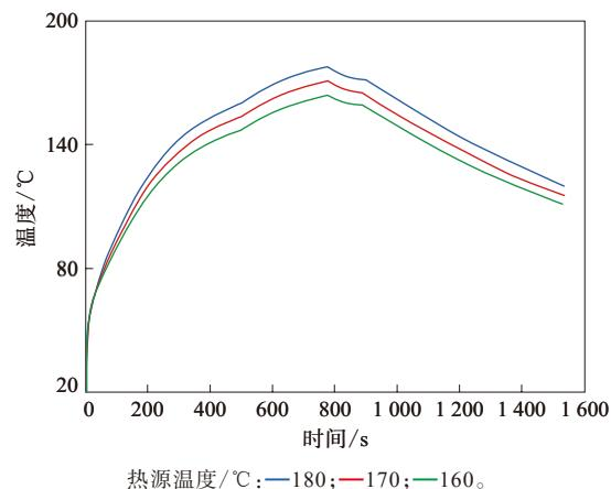
图5 不同热源温度下1#采样点的温度-时间曲线
