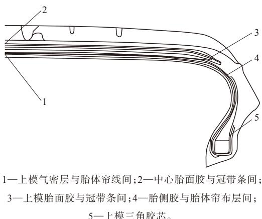
图2 温度采样点示意
