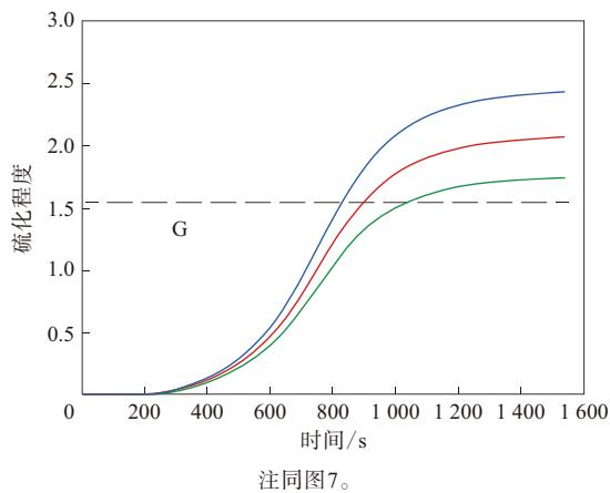
图8 不同预热温度下1#采样点的硫化程度-时间曲线
