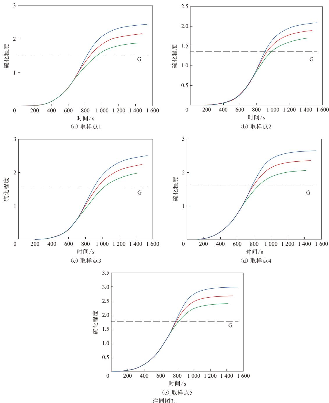
图4 不同硫化时间下各采样点的硫化程度-时间曲线
