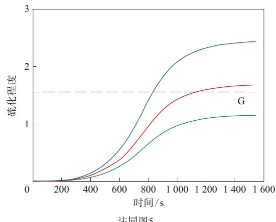
图6 不同热源温度下1#采样点的硫化程度-时间曲线
