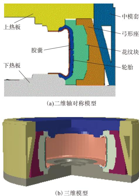
图1 轮胎硫化有限元模型
