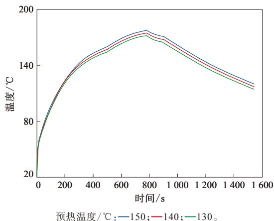
图7 不同预热温度下1#采样点的温度-时间曲线
