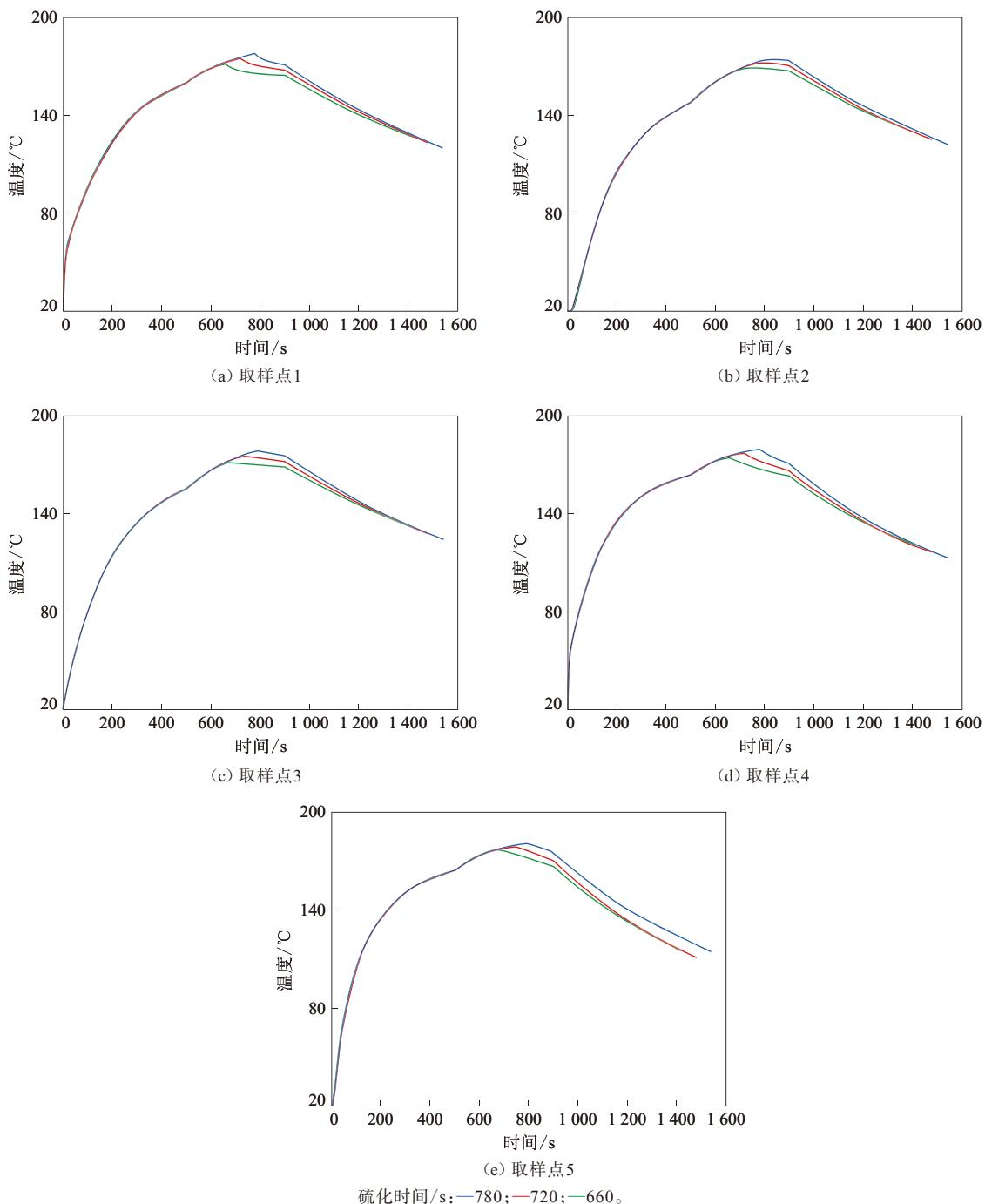
图3 不同硫化时间下各采样点的温度-时间曲线
