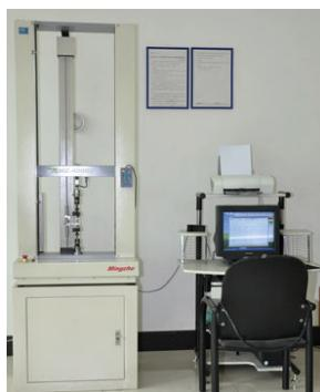
图1 拉力试验机
