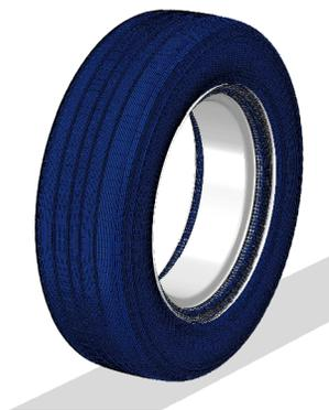
图4 轮胎三维有限元模型
