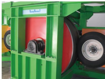
图1 滚动阻力测试示意
