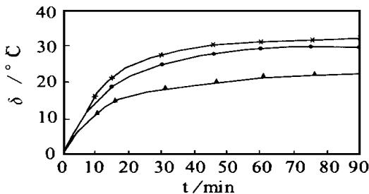
图 2 速度为  $70 \text{ km} \cdot \text{h}^{-1}$  的轮胎表面各部位温升-时间曲线
