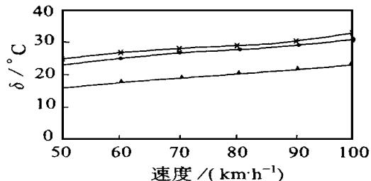
图 5 稳态时轮胎表面各部位温升随速度变化曲线
