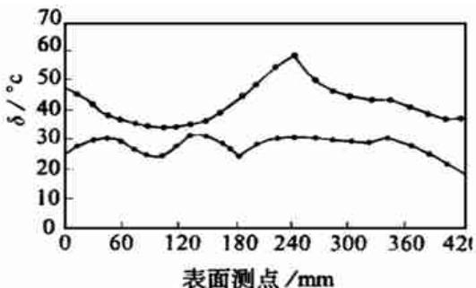
图6 稳态运行时及停机后轮胎表面各部位
