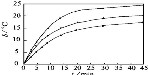
图 3 胎冠部位在不同速度下的温升-时间曲线
