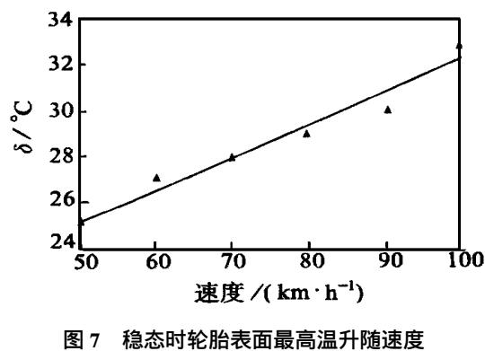
图7 稳态时轮胎表面最高温升随速度
