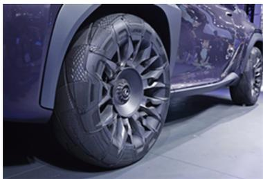
图1 采用固特异高科技激光雕刻技术设计的轮胎
