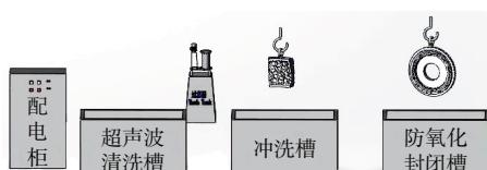
图3 超声波清洗装置
