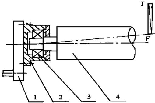
图 2 采用 1208 轴承的压紧辊安装结构
