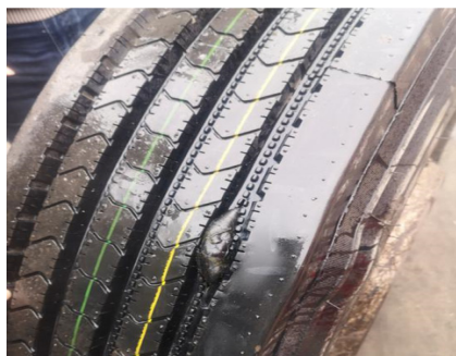
图5 刀板切割后的试验轮胎
