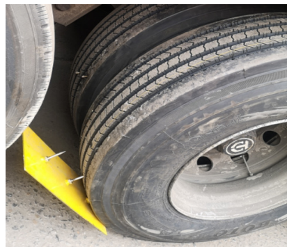
图2 无螺纹钢钉板测试
