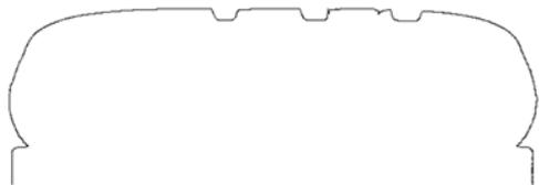
图1 超高速轮胎断面轮廓示意
