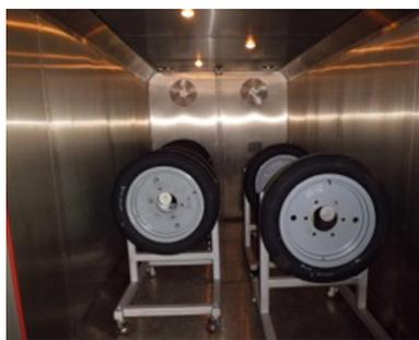
图1 轮胎高温老化试验箱
