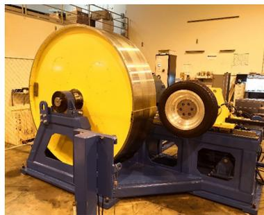
图25 轮胎冲击噪声测试
