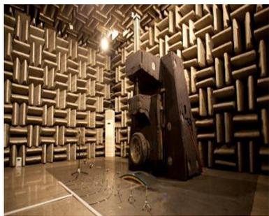
图21 轮胎室内噪声测试
