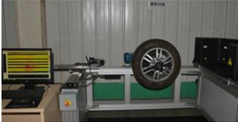
图27 轮胎耐磨性能测试
