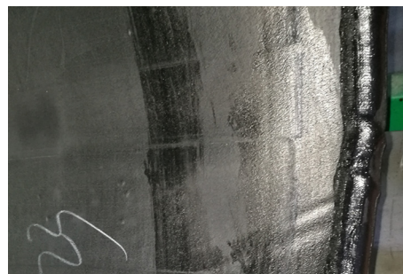
图1 轮胎胎圈或胎体反包处打褶/起泡层打褶或起泡。
