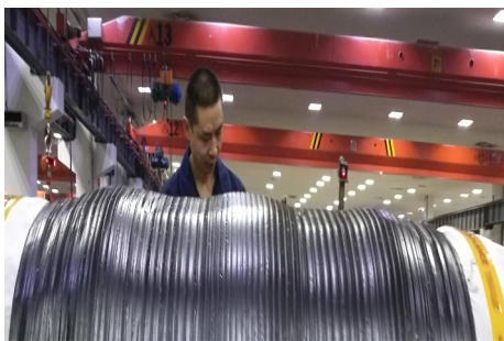
图3 缠绕胎面几何尺寸调试
