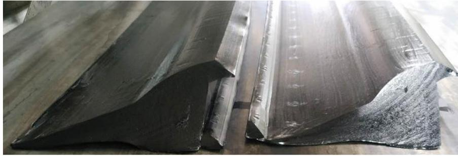
图3 结构调整前(左)后(右)口型板照片
