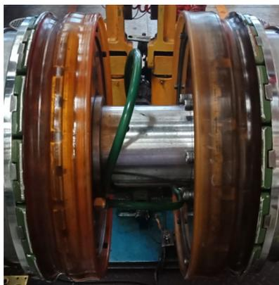
(b) 聚氨酯环式结构二段机头
