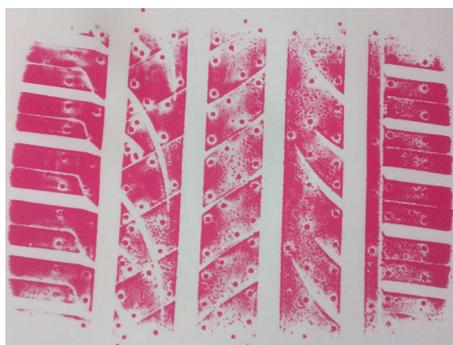
图3 轮胎接地印痕
