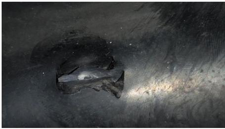
图9 硫化胶囊内表面脱层裂口
