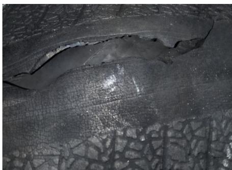
图7 硫化胶囊外表面中缝脱层裂口
