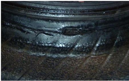
图3 硫化胶囊颈部裂口
