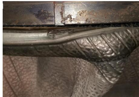
图5 硫化胶囊上夹盘排气槽位置裂口
