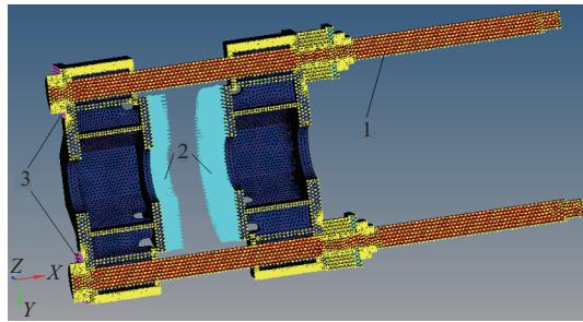
图2 多接触面轮胎定型硫化机有限元模型
