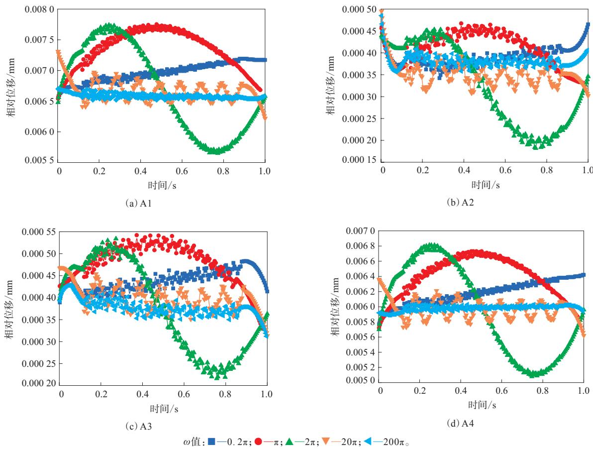
图6 周期性载荷频率变化对节点副相对位移的影响
