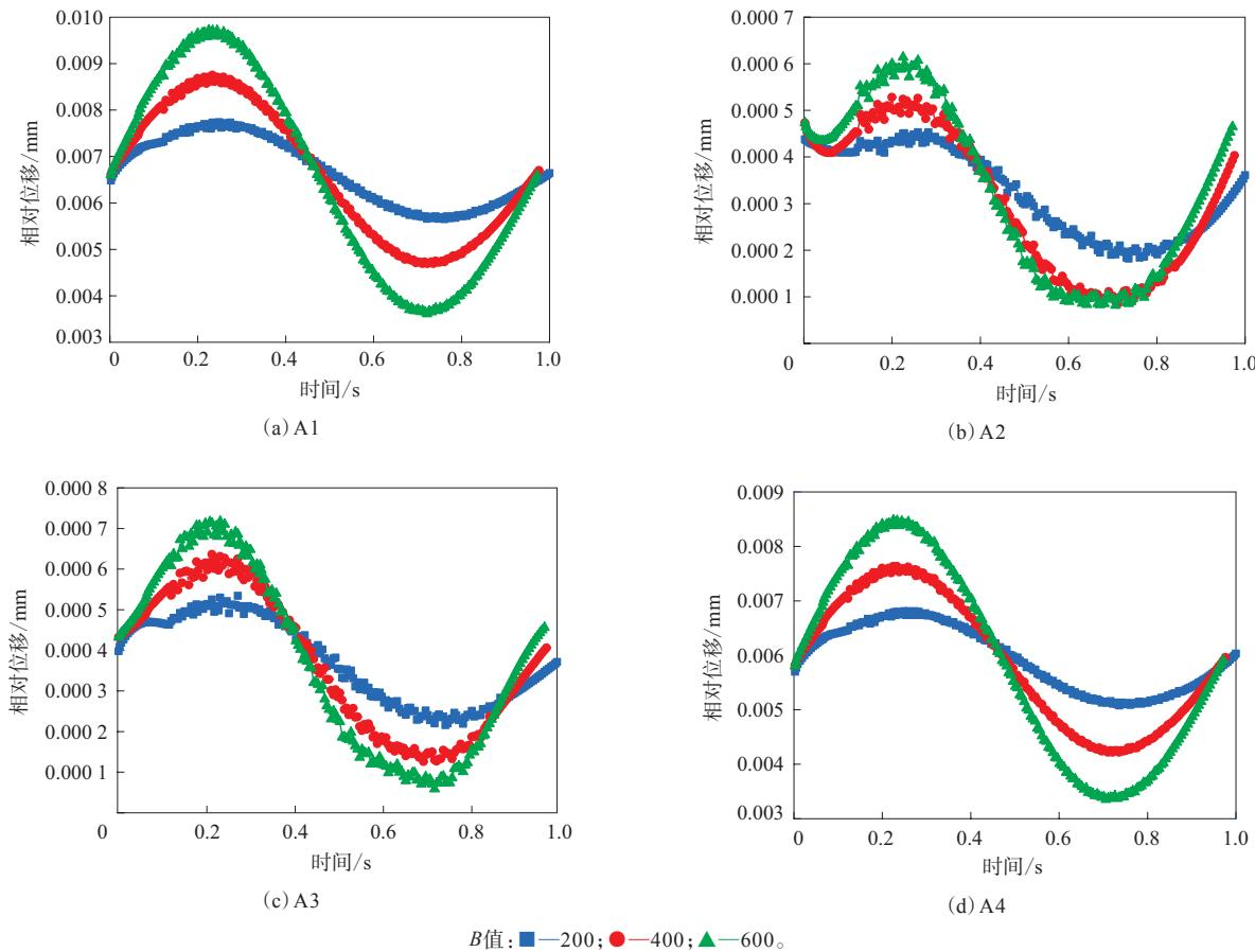
图5 周期性载荷振幅变化对节点副相对位移的影响
