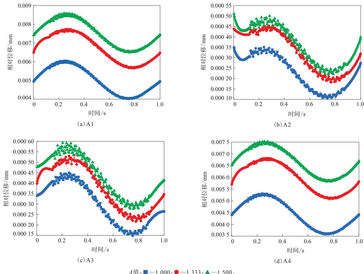
图7 周期性载荷基础值变化对节点副相对位移的影响
