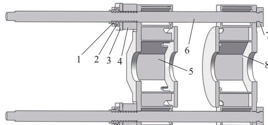
1—夹紧块;2—压板;3—底板;4—增压油缸;5—横梁;
